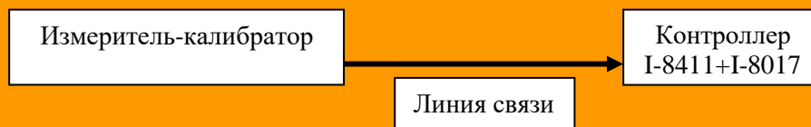
Рис.6 - Схема подключения средств испытаний к ИК избыточного давления жидкости и газа.
